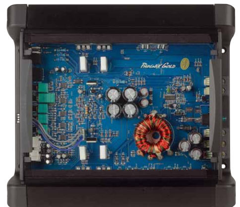
Die kleine Mono gehört zu den wenigen Monoverstärkern, die nach dem Class-A/B-Prinzip arbeiten
