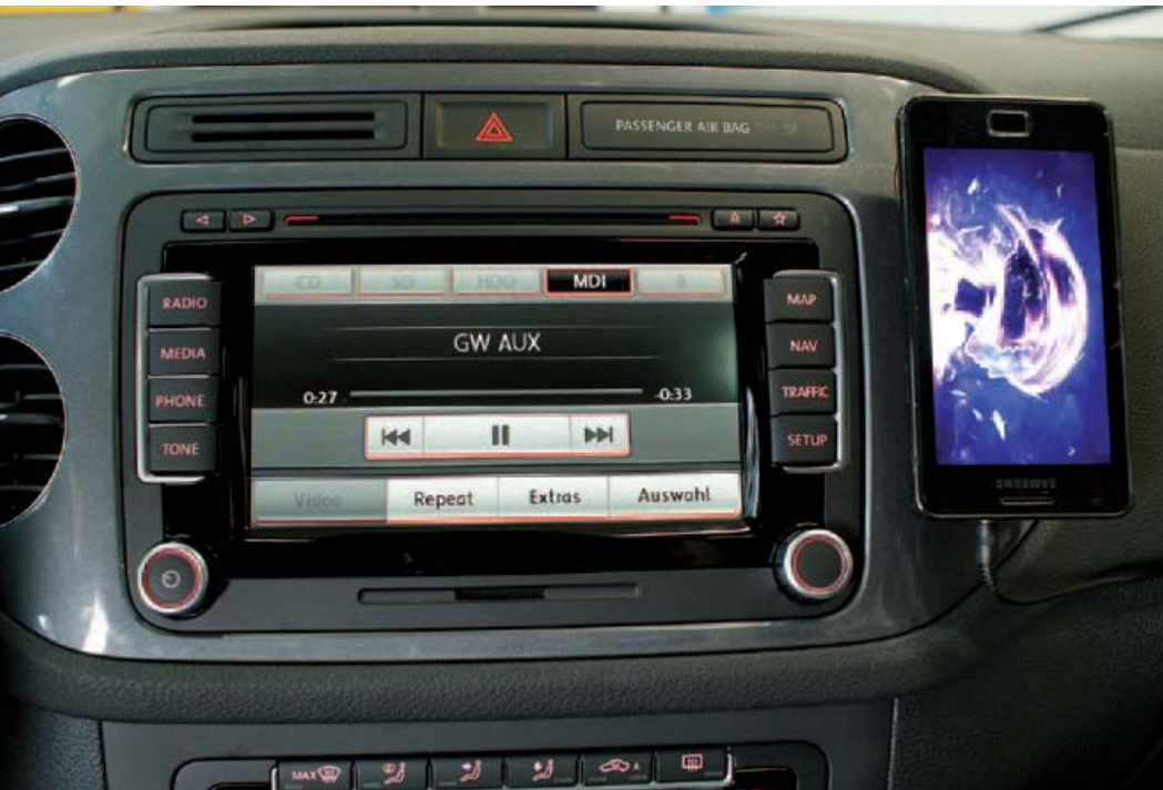
Einbau einer Infotainment-Lösung: Zunächst wird die Radioblende entfernt, das Radio heraus-, die Kabel abgezogen.
