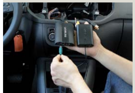
Nach der Installation des Denison Gateway lassen sich Erweiterungen wie beispielsweise ein DAB+-Interface anstecken (rechts).
