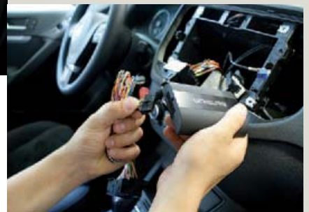
Ein Gerät der Denison Gateway-Reihe wird per Adapter am Kabelsatz des Pkw angeschlossen. Fotos: maxxcount.de
