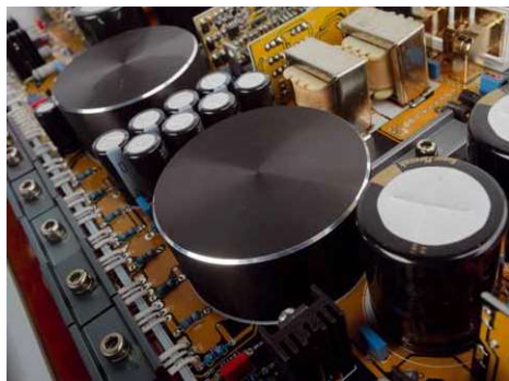
Die geschirmten Netztrafos kommen aus Deutschland von Epcos
